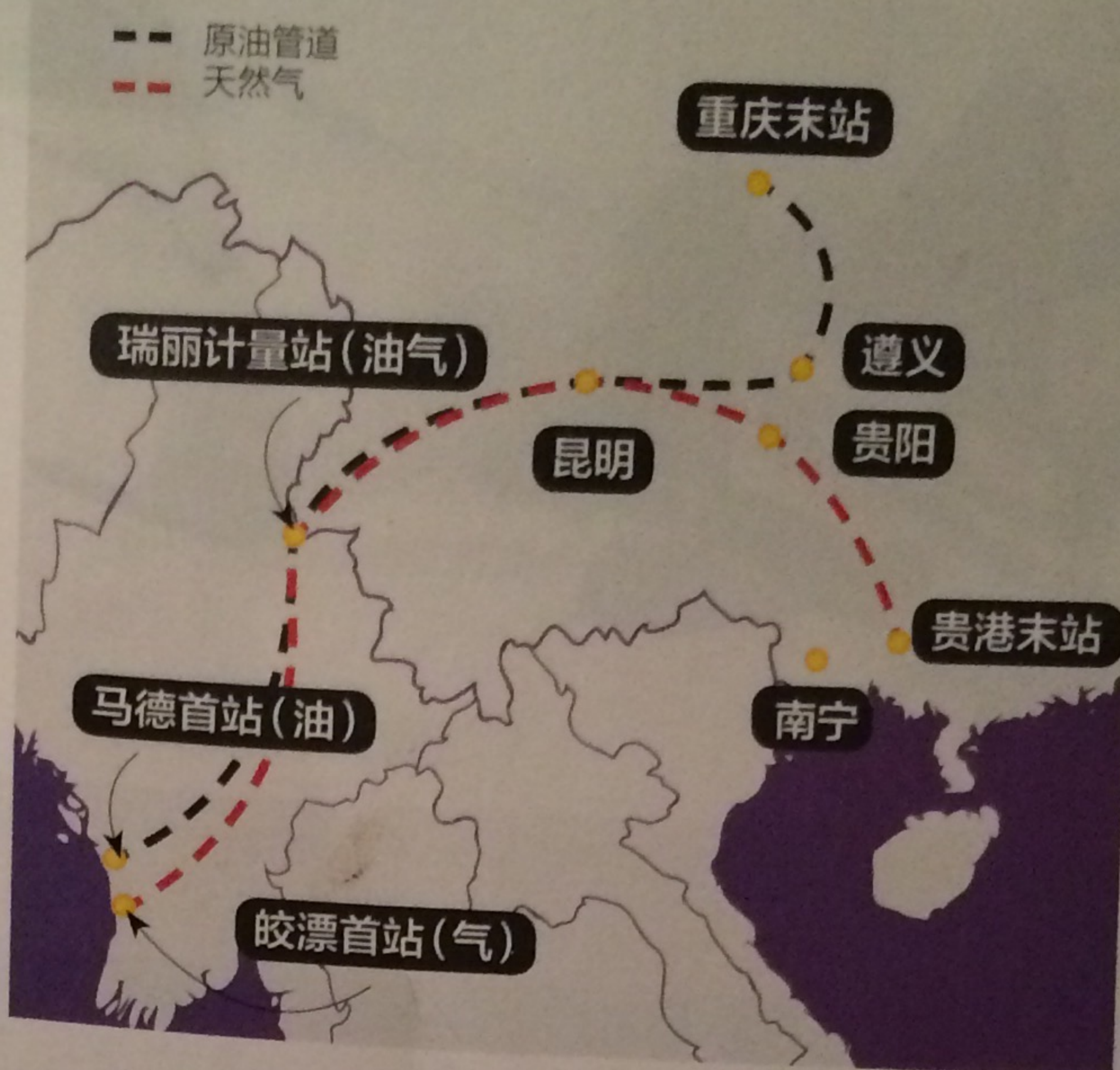
中缅油气管道路线图
